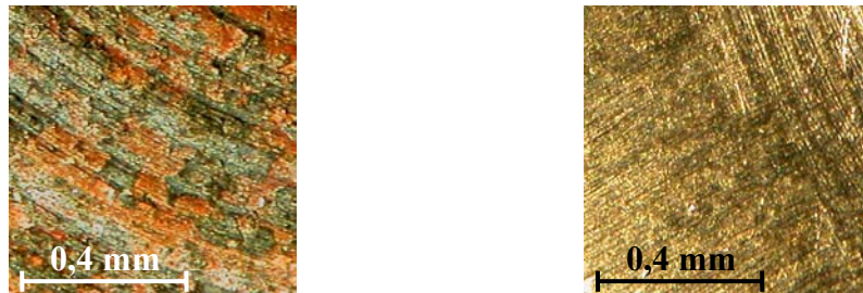
Figure II.15 : Aspect des électrodes haute-tension de cuivre (à gauche) et de titane-vanadium (à droite) après quelques minutes d'utilisation en régime de décharge
