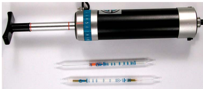
Figure AIII.4 : Tubes colorimétriques normalisés et pompe de prélèvement Gastec pour les mesures de concentration des NO x (50 à 2500 ppm) et de CO (0,1 à 5 %)
